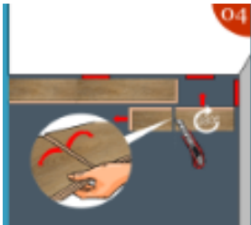
Fig 5, 6- Deuxième rangée : la première planche doit avoir un minimum de 8" en longueur. Enclenchez-la en place du côté long. Enlignez et rapprochez la deuxième latte ou tuile afin d'enclencher solidement les deux lames ou tuiles du côté long et court. Utilisez le maillet caoutchouc, tapotez légèrement afin d'assurer un enclenchement serré et solide.
